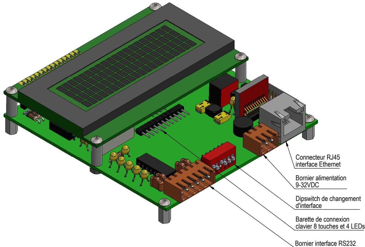
**Pinout barette de connexion de gestion 8 touches matricées et 4 LEDs**
